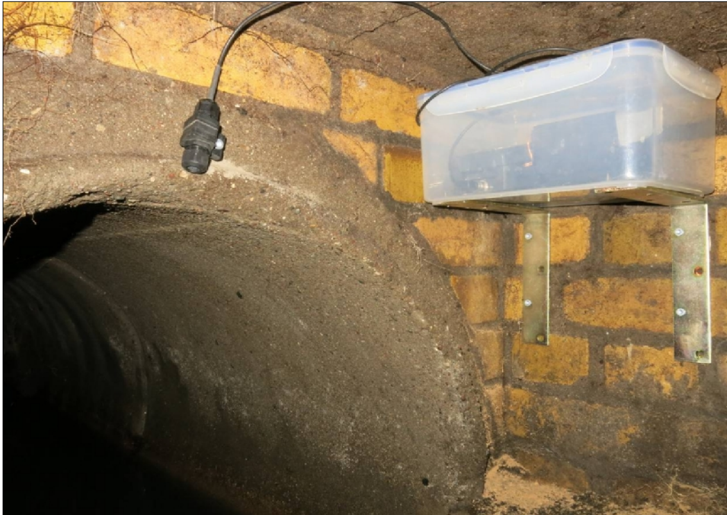
Abb. 2: Im Schacht installierte Horchbox Batlogger A. Das abgesetzte Mikrofon wurde unmittelbar über der Rohrleitung installiert, so dass durchfliegende Tiere optimal erfasst werden könnten.
