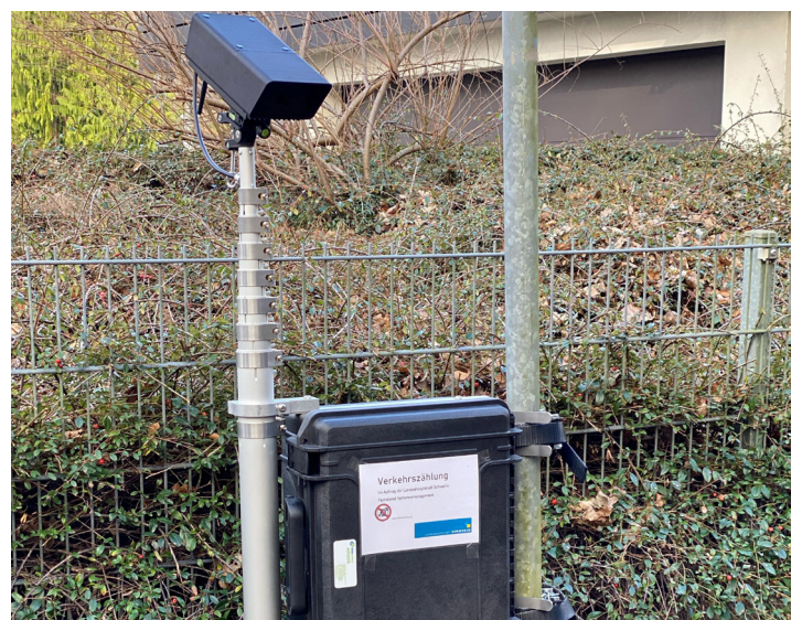
Mit dem Kamerasystem werden die Verkehrsdaten automatisch erfasst. © LHS
